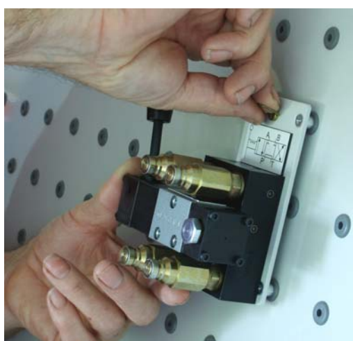
Insteekmodules worden met kwartslagmoer vastgezet op het montagepaneel
