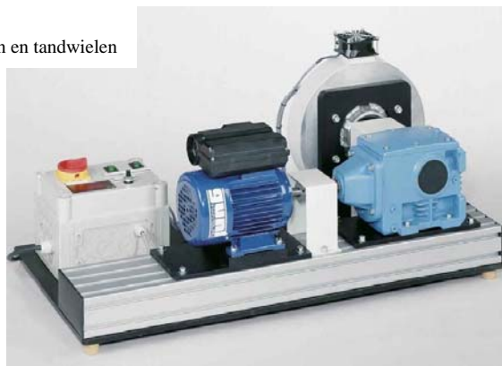
Werkingsprincipe haakse worm en wormwiel tandwielkast
